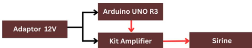
**Gambar 1.** Blok diagram perancangan alat
