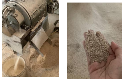
Gambar 2. Proses Pemisahan Beras ( Mesin Poles 1 )
